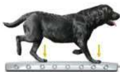
Plataforma de fuerza biomecánica con báscula integrada. Velocidad entre 1,7 y 2,1 m/s
